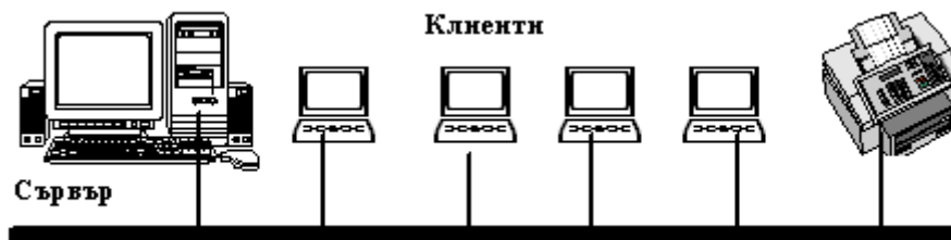
Фиг. 3. Изобразява структурата на клиент – сървър в мрежата
